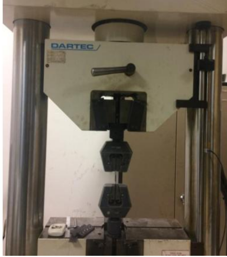
řekil 5. rneklerin mekanik testlerinin gerekleřtirildiđi DARTEC niversal ekme cihazı.
