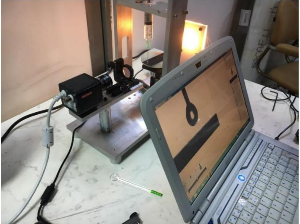
Şekil 4. Yüzeylerin karakterizasyonunda kullanılan temas açısı ölçüm cihazı.
